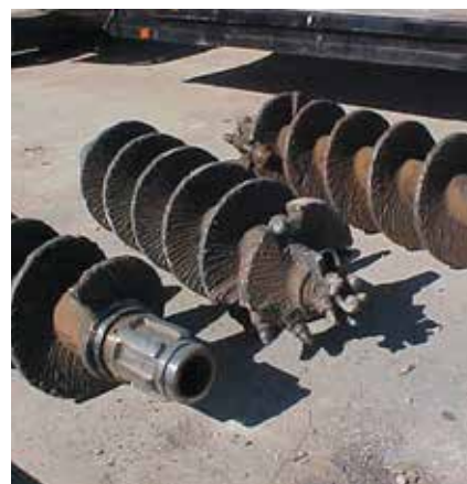
Восстановление шнека с помощью Stody 101HC
