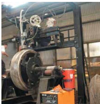
Восстановление вала дробилки с помощью Stody 100HC
