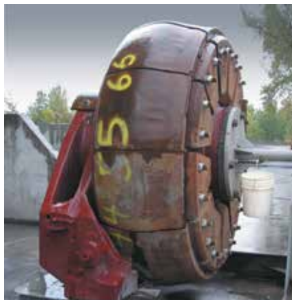
Восстановление сегментного вальца с помощью Stody 100HD
