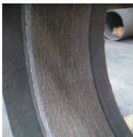
Облицовка внутреннего диаметра труб с помощью Stody CP-2000
