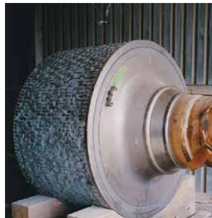
Восстановление вальца роликового пресса с помощью ThermoClad Roll Build 3 и наплавка с помощью Stody 600
