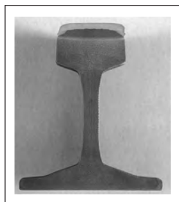
Головка рельса, наплавленная проволокой Tubrodur 15.43
