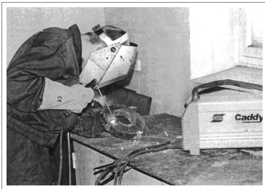
Приварка звездочки к оси электродами OK 68.82 .
