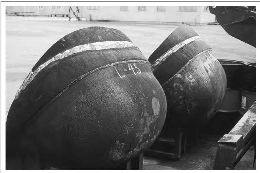
Черпаки с новыми рабочими поверхностями, приваренные с помощью электродов OK 68.82 .
