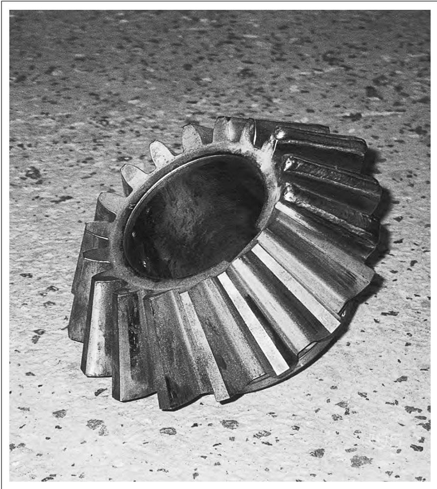
Коническая шестерня, наплавленная электродами ОК 68.82.
