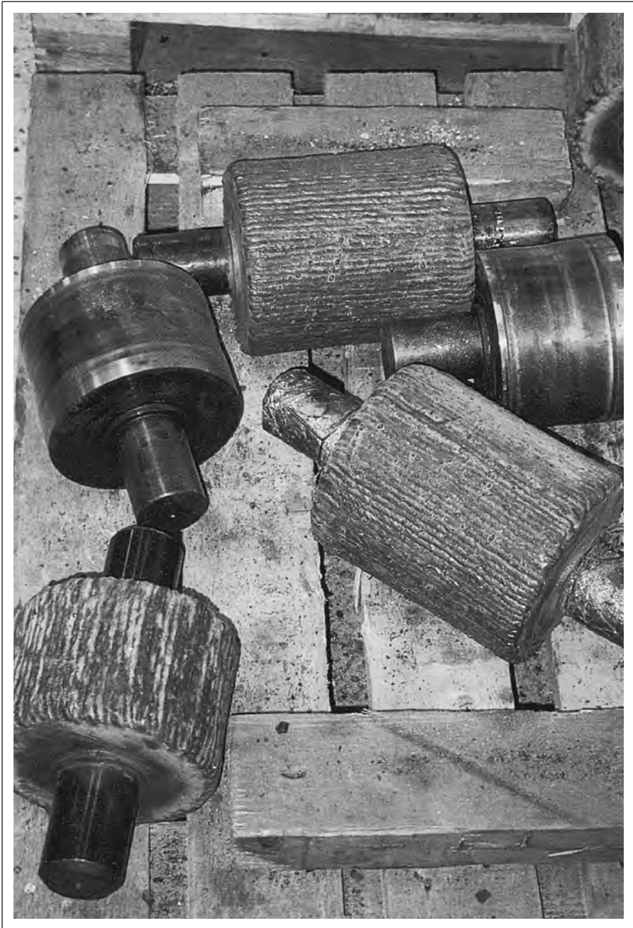
Поддерживающие ролики, наплавленные электродами ОК 84.52 и ОК 93.06.
