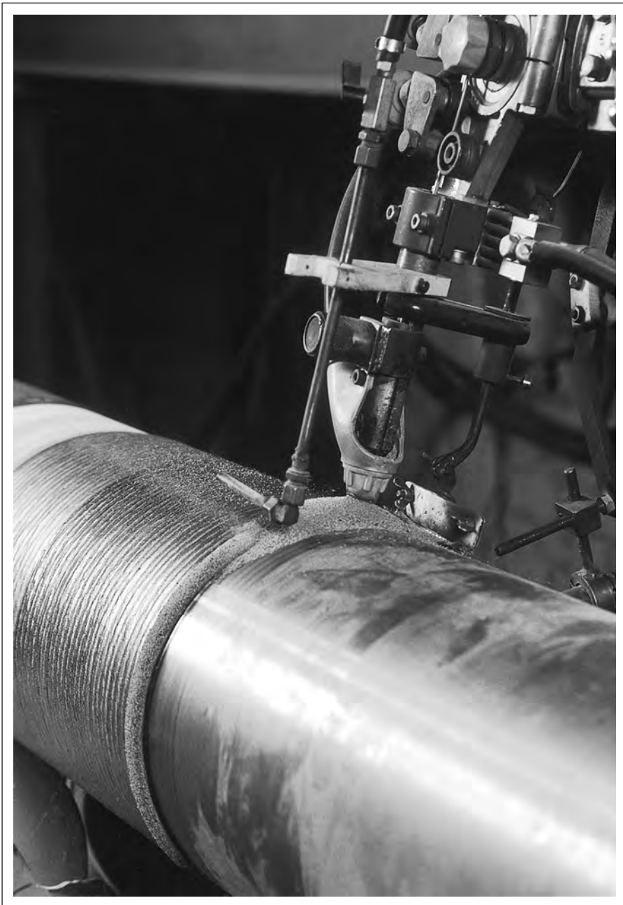
Наплавка ролика проволокой OK Tubrodur 15.72S под флюсом OK Flux 10.33 на автомате марки A6 HD SAW фирмы ESAB для сварки под флюсом.
