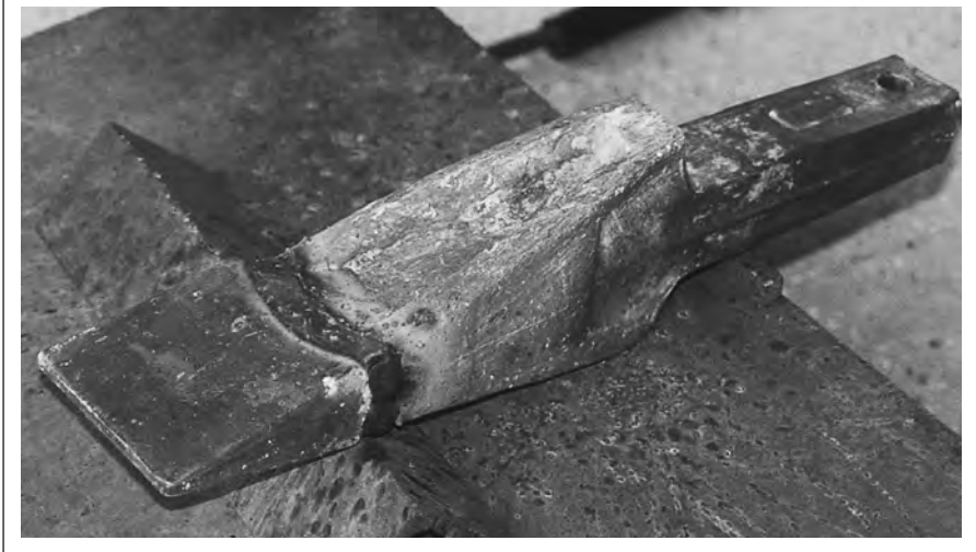
Новая рабочая часть подбойки, приваренная с помощью электродов OK 67.45 и проволоки OK Tubrodur 14.71 .
