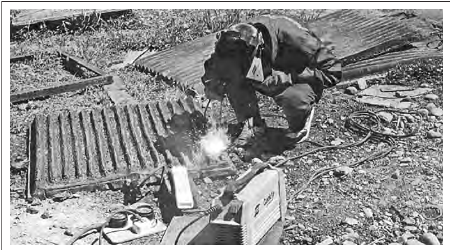
Наплавка плит дробилок из стали Гадфильда с помощью электродов OK 86.28 .
