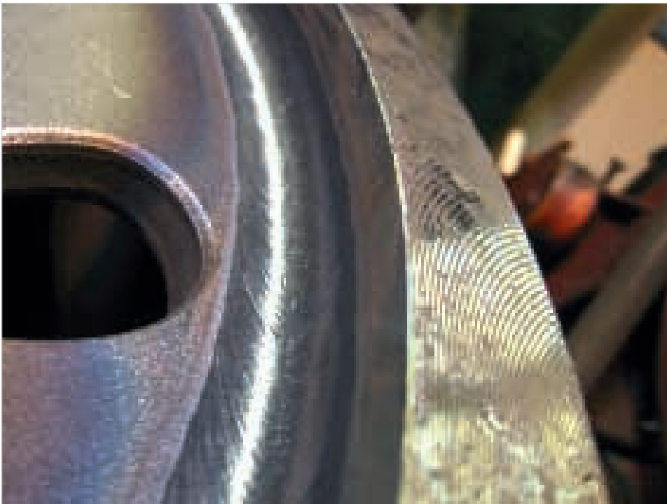
Угловой шов, выполненный в нижнем положении Н1(РА) (в лодочку), с отличным смачиванием свариваемых кромок и гладкой поверхностью.
