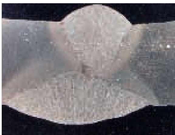
Недостаточное проплавление и чрезмерное усиление шва, а также смещение шва от стыка.
