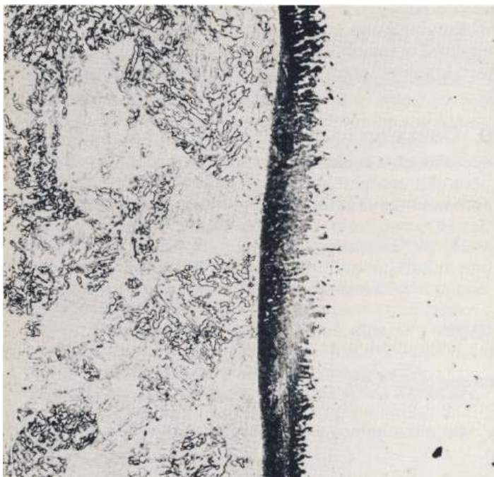
Рис. 5. Сварка низколегированной стали 2,3%Cr-1%Mo с высоколегированной 16%Cr-10%Ni-Nb. Металл шва: 18%Cr-10%Ni-Nb. Хрупкая насыщенная углеродом зона по границе линии сплавления образовалась за счет миграции углерода из стали 2,3%Cr-1%Mo (после выдержки в течении примерно 9 000 час в диапазоне температур от 500 до примерно 600°C). Увеличение 100х.
