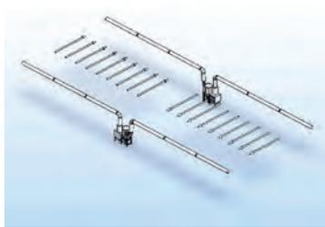
Двойная параллельная система Push-Pull с двумя фильтрами и двумя вентиляторами.
