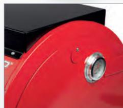
Отверстие для выпуска влаги регулируемого размера позволяет контролировать содержание влаги внутри камеры.
