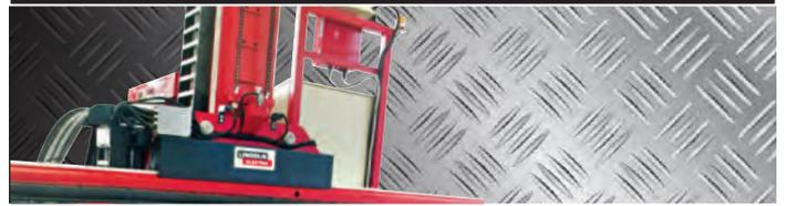
Безвибрационные колонны и консоли для точного позиционирования сварочной головки при автоматической сварке изделий разных размеров – от небольших труб до крупных резервуаров. Дополнительные роликовые настилы значительно упрощают продольную и окружную сварку.
