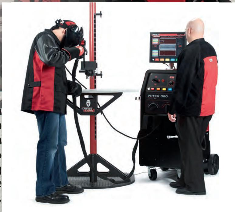
Система VRTEX® даже может имитировать соответствующую настройку аппарата. Перед началом «сварки» практиканты должны указать тип материала, процесс сварки, расход защитного газа, силу тока, напряжение и скорость подачи проволоки.
