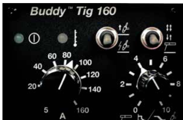
Панель управления Buddy™ Tig 160 имеет одну ручку для настройки сварочного тока, а другую для настройки времени падения тока в режиме TIG или силы дуги в режиме MMA.
