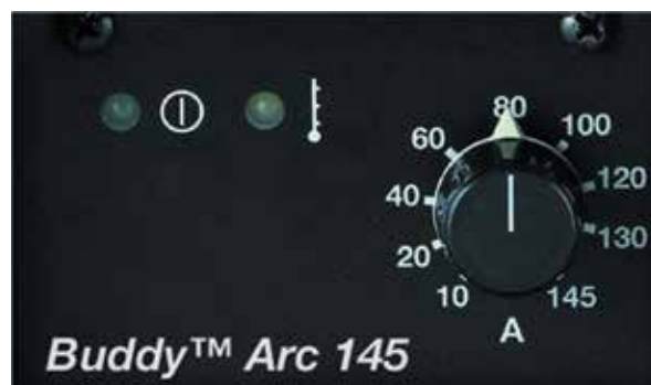
Панель управления Buddy™ Arc 145 чрезвычайно проста в использовании – на ней предусмотрена всего одна кнопка для настройки сварочного тока.
