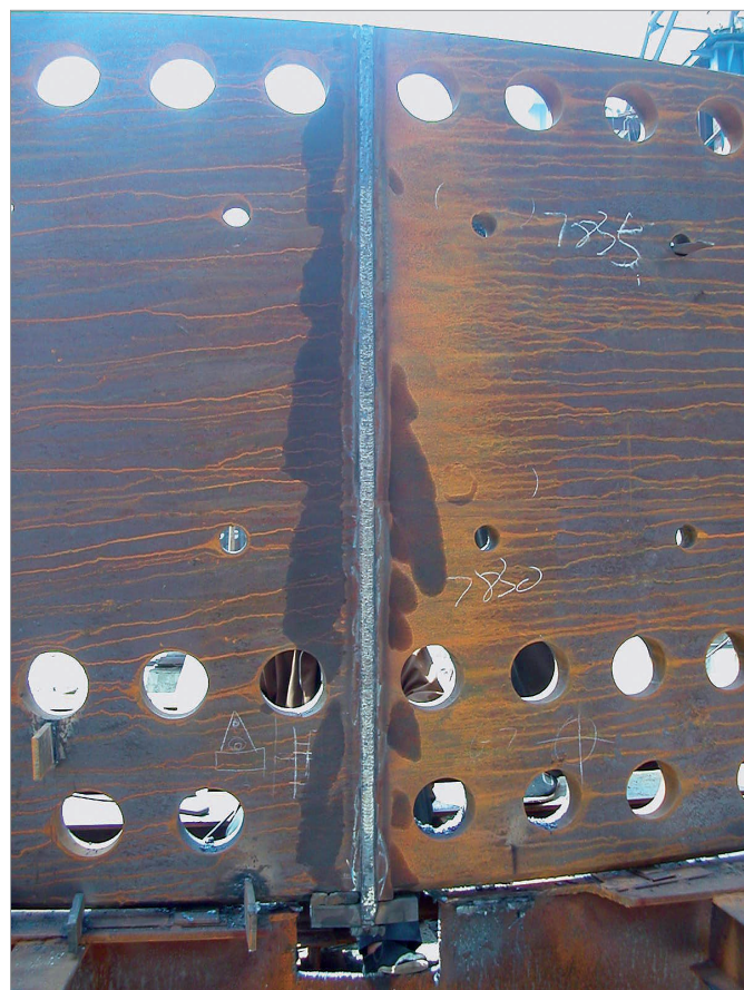
Образец электрогазовой сварки кожуха доменной печи
