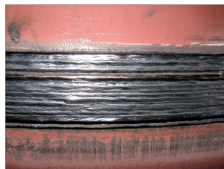
Образец наплавки с использованием установки AGW-P с источником Lincoln Electric POWER WAVE 1000 AC/DC
