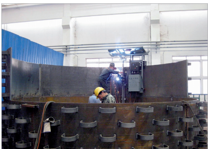
Сварка секции обсадной трубы шахтного ствола с использованием установки EGW
