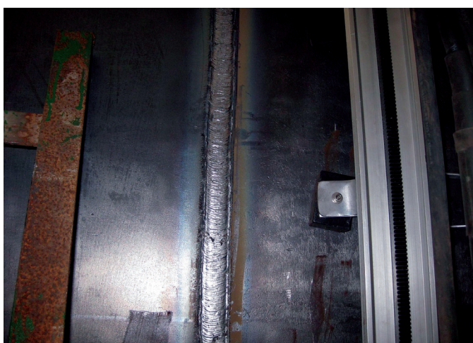
Образец шва, полученного при использовании установки электрогазовой сварки
