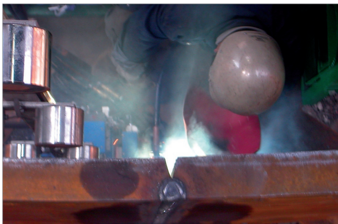
Электрогазовая сварка в X-образную разделку
