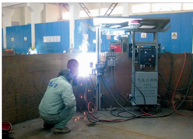
Сварка секции обсадной трубы шахтного ствола с использованием установки EGW
