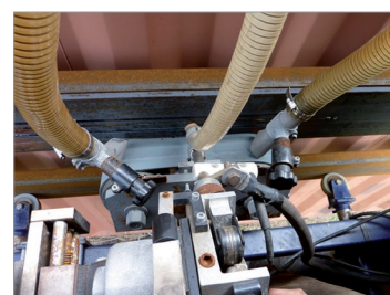
Сварочный узел установки для двухсторонней сварки резервуаров
