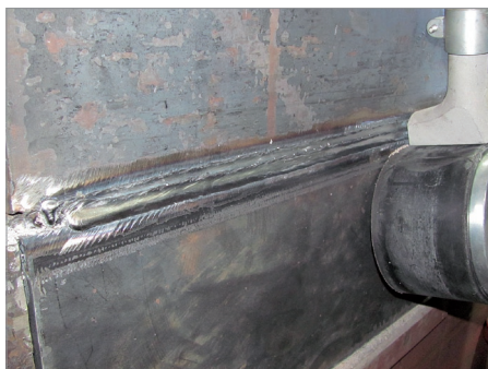
Образец шва, полученного при использовании установки AGW-P с источником Lincoln Electric POWER WAVE 1000 AC/DC
