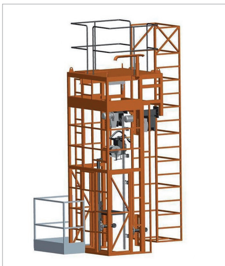
Балкон для контроля сварки вертикальных швов
