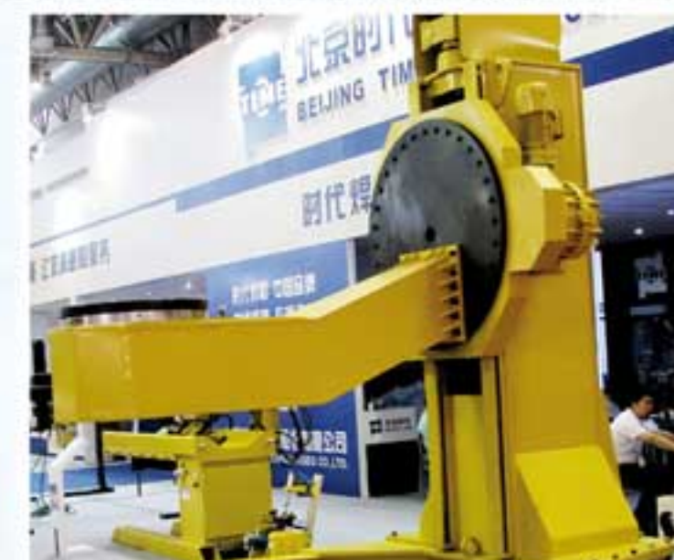
Сварочный позиционер грузоподъемностью 10 т
