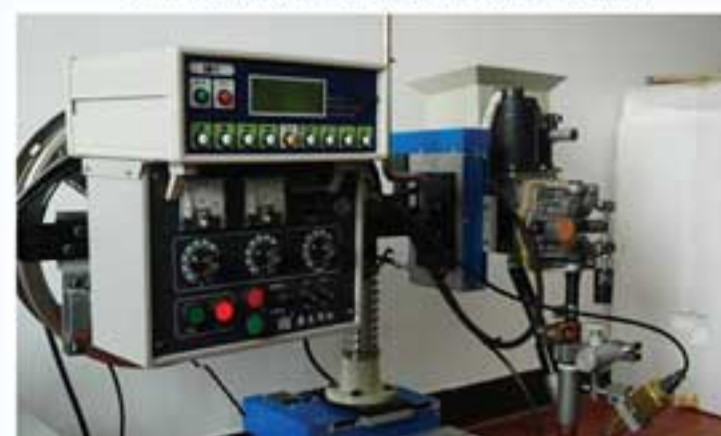
Система отслеживания сварочного шва, установленная на сварочный трактор
