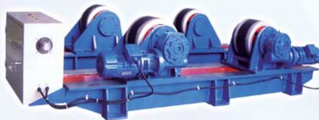
Самонастраивающийся вращатель грузоподъемностью 100 т
