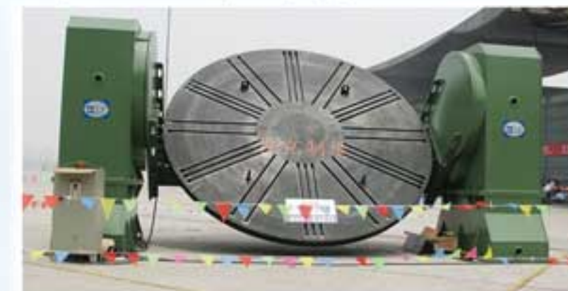
Сварочный позиционер грузоподъемностью 160 т
