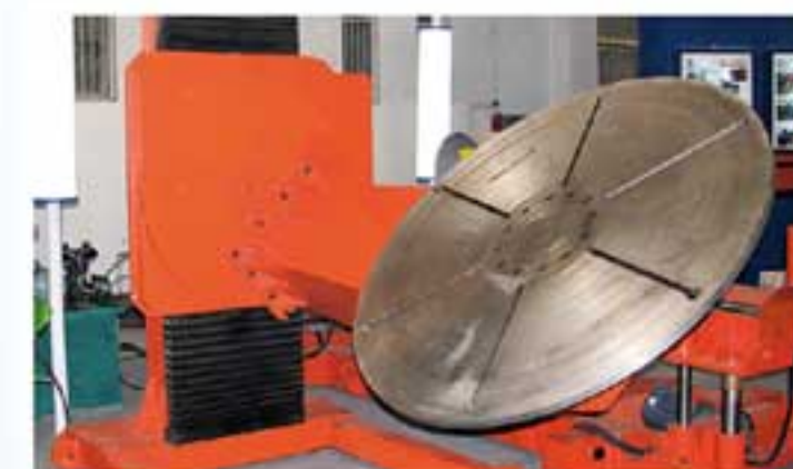
Сварочный позиционер грузоподъемностью 5 т
