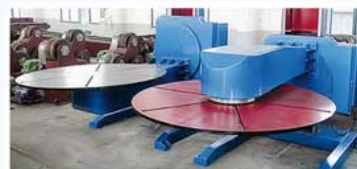
Сварочный позиционер грузоподъемностью 5 т
