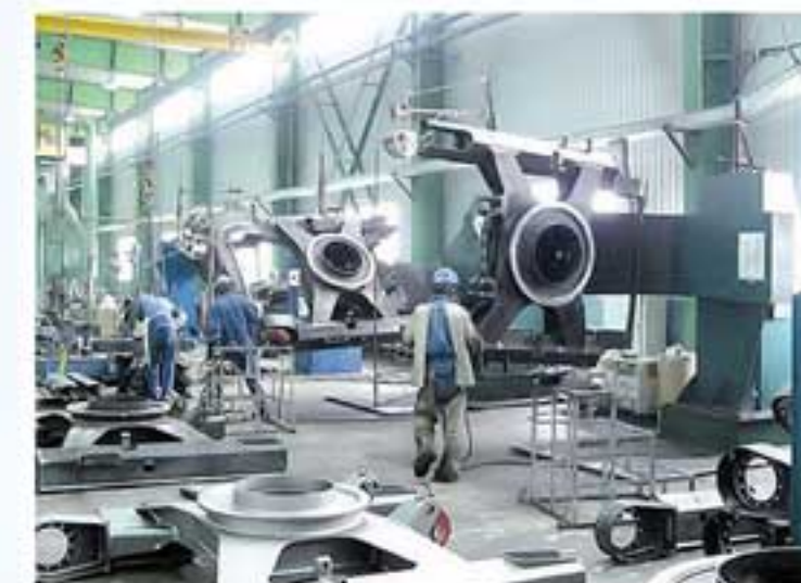
Сварочный позиционер грузоподъемностью 5 т
