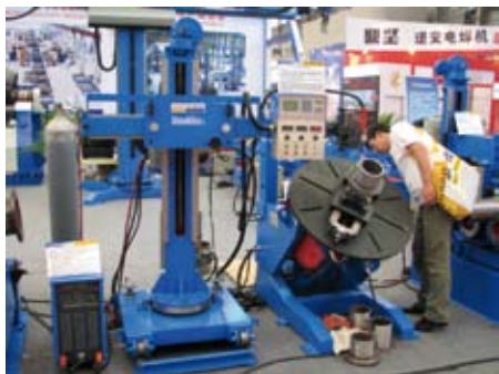
Сварочный комплекс, включающий мини колонну с осциллятором и сварочный позиционер с зажимным патроном
