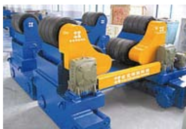
Самонастраивающийся вращатель с широкими роликами с одним электроприводом на тележке с приводом
