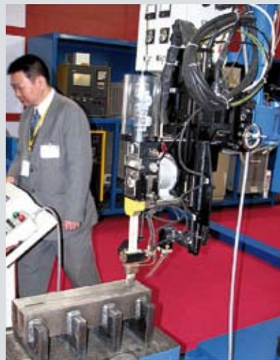
Установка для сварки в узкощелевую разделку
