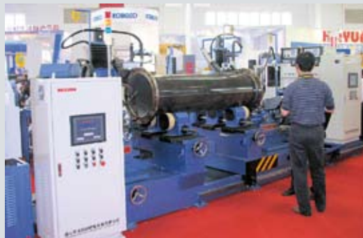
Автоматический комплекс для двухсторонней приварки фланцев четырьмя горелками одновременно
