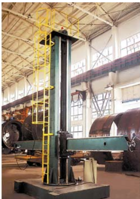
Тяжелая П-образная колонна обеспечивает высокую жесткость конструкции и точное позиционирование сварочной головки в процессе сварки
