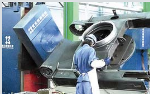
Позиционер грузоподъемностью 5 т
