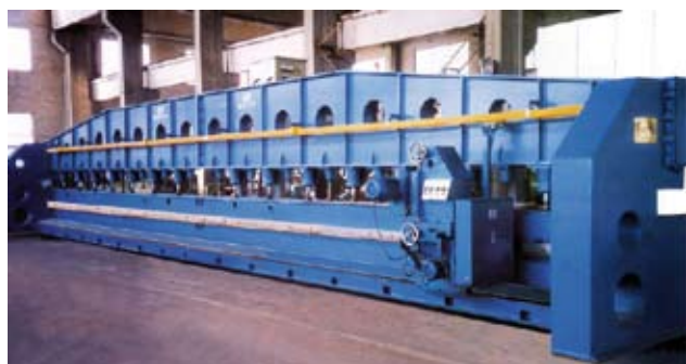
Станок для обработки кромки листа под сварку
