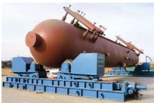
Мобильный вращатель грузоподъемностью 500 т с системой компенсации смещения обечайки
