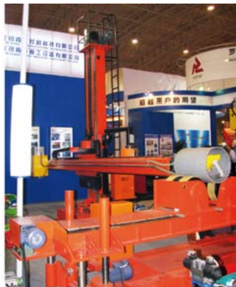
Сварочный центр в составе сварочной колонны и роликовых вращателей. Сварочная колонна оснащена компактной сварочной головкой для сварки труб малого диаметра с системой видеонаблюдения. В роликовом вращателе перемещение роликов в горизонтальной плоскости и перемещение станины в вертикальной плоскости осуществляется с помощью электродвигателей.
