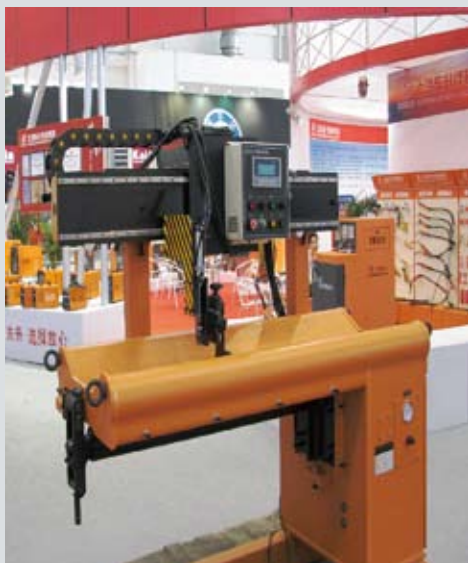
Установка для автоматической сварки продольных швов
