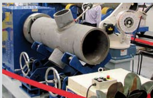
Роботизированный комплекс для приварки патрубков
