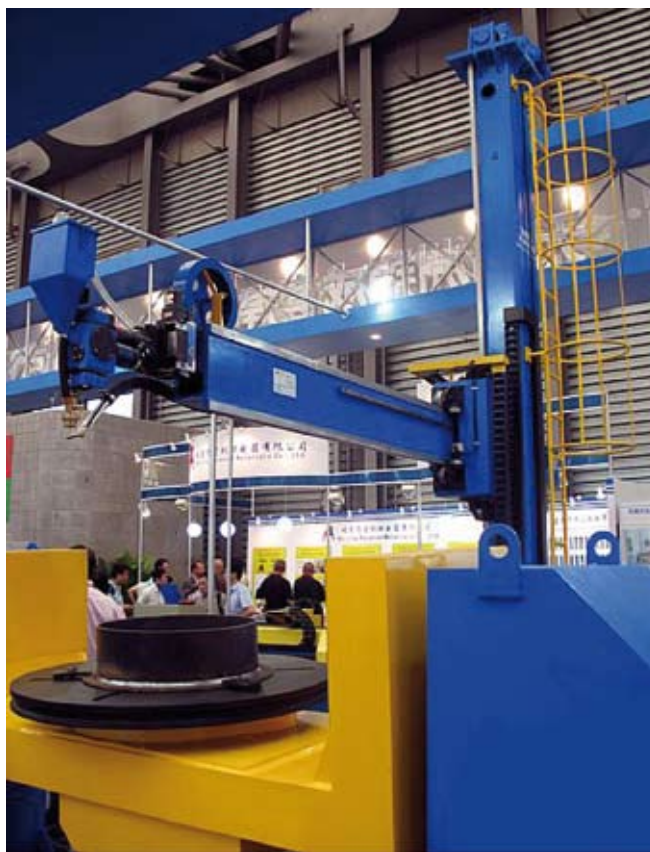
Сварочный комплекс: средняя сварочная колонна и позиционер колыбельного типа
