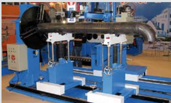
Стенд для приварки отводов
