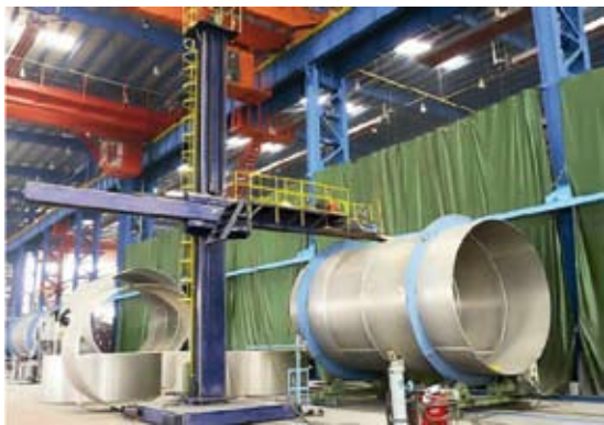
Тяжелая сварочная колонна с помостом
