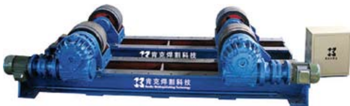
Сварочный роlikовый вращатель с настройкой на необходимый диаметр свариваемого изделия вручную за счёт перемещения блоков роlikоопор. В нужном положении блоки фиксируются болтами.
