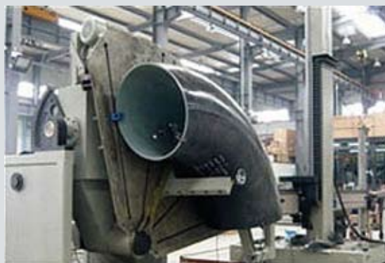
Установка для изготовления сварных (штампосварных) отводов
