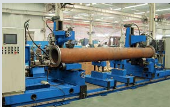
Автоматический комплекс для двухсторонней приварки фланцев четырьмя горелками одновременно
