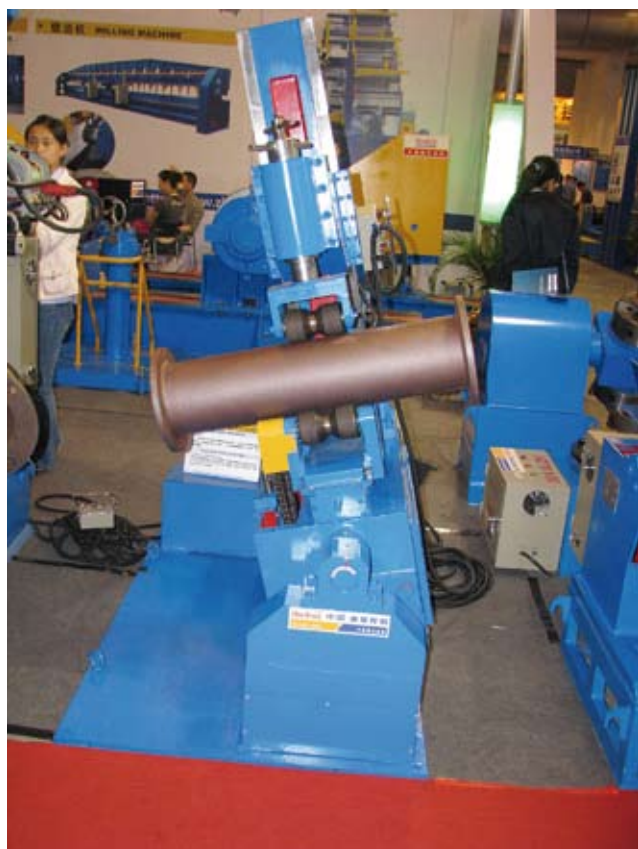
Трубный вращатель GGLJ-1000. Обеспечивает возможность наклона детали на угол до 45°
