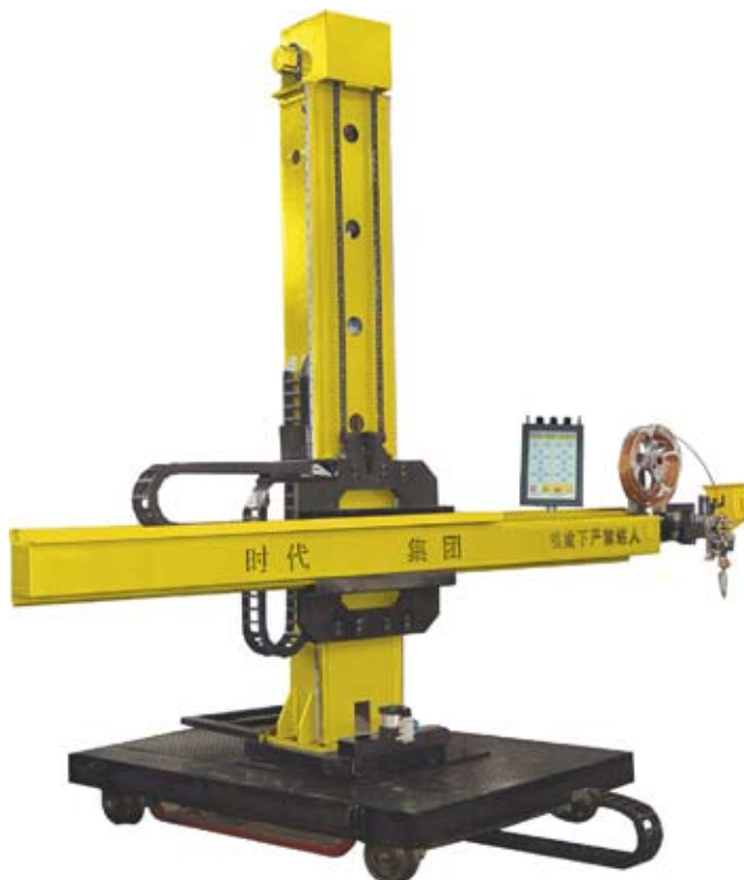
Сварочный центр с единым пультом управления для колонны и вращателя
