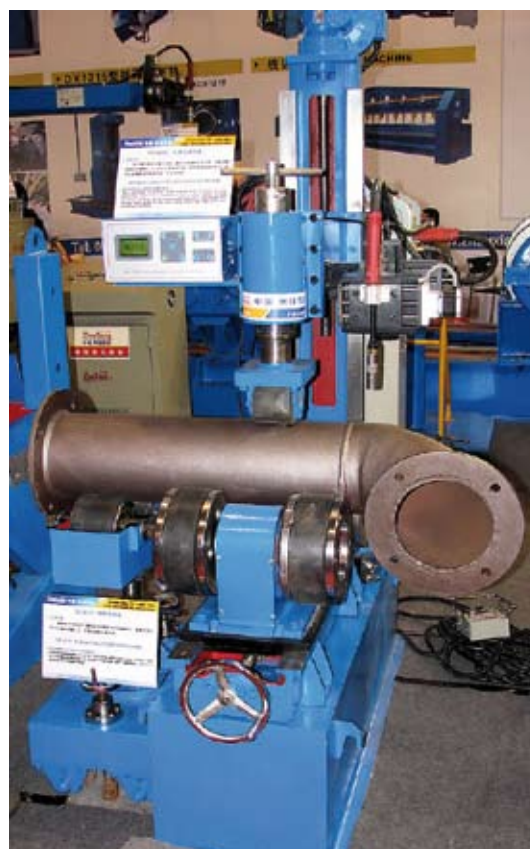
Трубный вращатель PPAW-05 с установленным осциллятором и дополнительной опорой г/п 5 т
