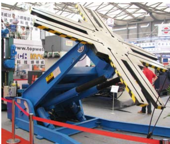
Позиционер с гидравлической системой подъема планшайбы
