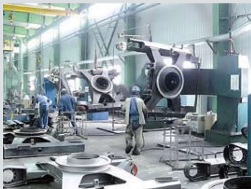
Позиционер грузоподъемностью 5 т
