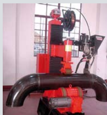
Трубный вращатель с головкой Lincoln Electric для сварки под флюсом
