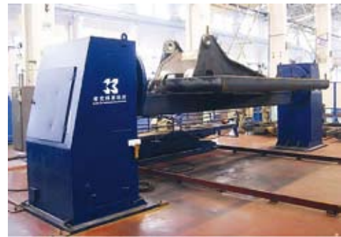
Сварочный позиционер грузоподъемностью 10 т
