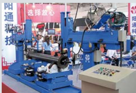
Стенд для приварки фланцев
