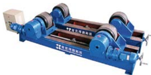
Сварочный роlikовый вращатель, настраиваемый с помощью винтовой передачи
