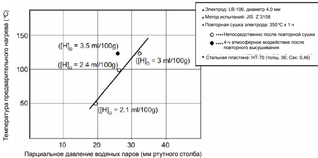
Рис. 10: Требования к температуре предварительного нагрева в зависимости от атмосферы в зоне сварки. ( H_D показывает содержание диффундирующего водорода в наплавленном металле, полученное глицериновым методом согласно JIS Z 3118)
