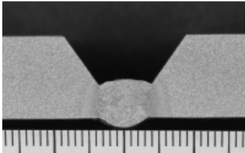
2) Хороший внешний вид наружного валика при проходе при заварке корня шва в процессе односторонней сварки.
