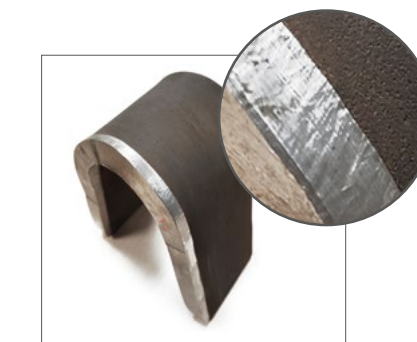
Образец для испытания на боковой загиб 180° для наплавки Ni-625 гибридным методом
