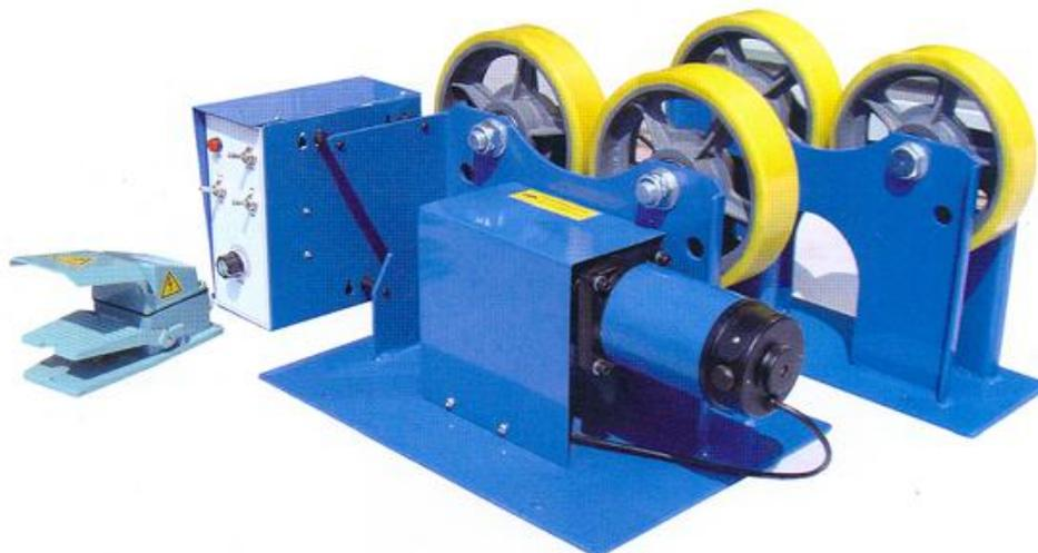
Сварочный вращатель состоит из двух секций: приводной и не приводной. Приводная секция оснащена электродвигателем мощностью 100 Вт. Вращатель имеют плавную регулировку скорости вращения. Роликоопоры вращателя могут фиксироваться в двух положения для настройки на необходимый диаметр свариваемого изделия. Для повышения сцепления с вращаемым изделием роликоопоры покрыты слоем полиуретана. В комплектацию вращателя входит пульт дистанционного управления – педаль.
