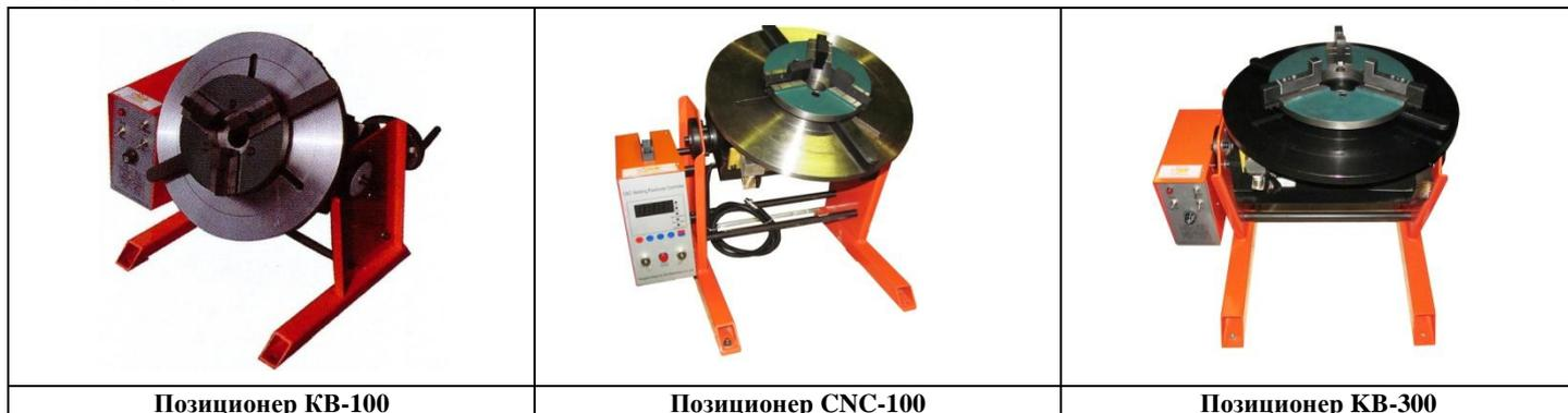
Позиционер CNC-100 оснащен шаговым двигателем и блоком ЧПУ. Блок позволяет задавать угол поворота стола с точностью до 1 градуса, а также устанавливать время задержки начала вращения стола.
