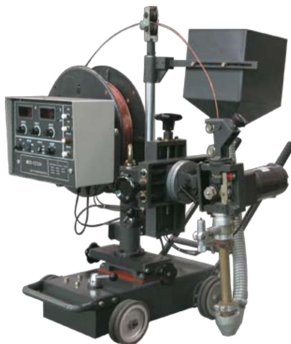
Сварочный трактор модели Н10
