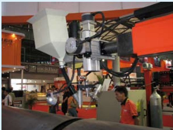
Сварочная головка с системой видеонаблюдения
