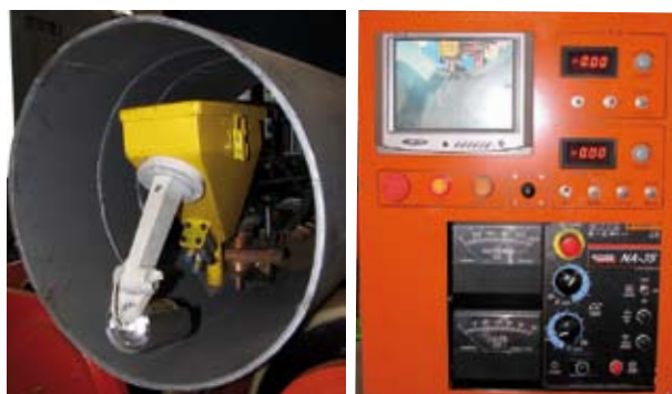
Компактная сварочная головка с системой видеонаблюдения
